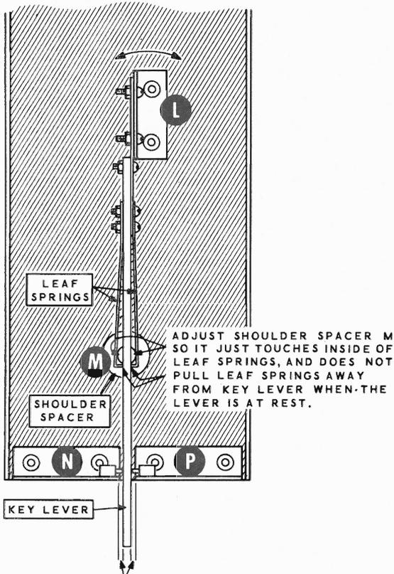
ADJUST SHOULDER SPACER M SO IT JUST TOUCHES INSIDE OF LEAF SPRINGS, AND DOES NOT PULL LEAF SPRINGS AWAY FROM KEY LEVER WHEN THE LEVER IS AT REST.
