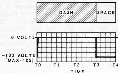
**Q8 COLLECTOR OUTPUT TO TRANSMITTER**
