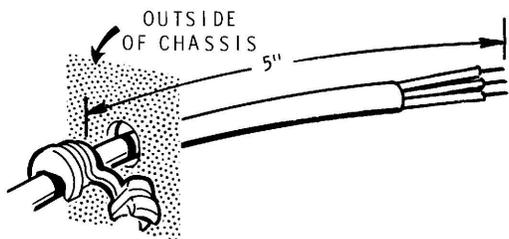
PLACE THE LINE CORD STRAIN RELIEF OVER THE CABLE.
